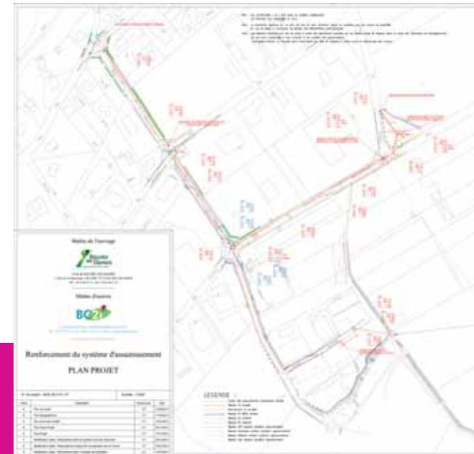
Les travaux qui doivent s'étaler sur plusieurs mois et se terminer en 2015 consisteront à construire un collecteur séparatif des eaux usées (EU) rue des Bouvreuil et rue du Tennis, à modifier, moderniser, supprimer et créer divers ouvrages de captage des eaux sur l'ensemble du périmètre, à créer une conduite de refoulement sur le secteur Rainettes et à renvoyer les eaux ainsi collectées vers des infrastructures récentes.
